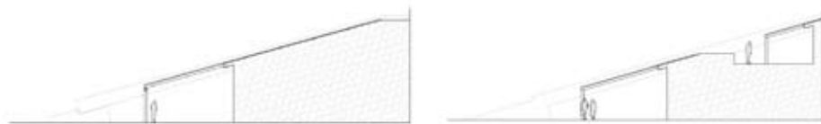
Schema di impianto fotovoltaico sulla copertura dell'edificio 04 (sezione B-B)
