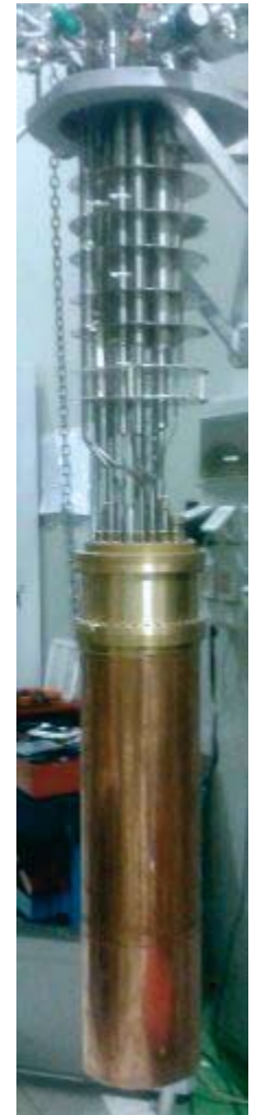
Fig. 1: Criostato a diluizione 3\text{He}/4\text{He} .
